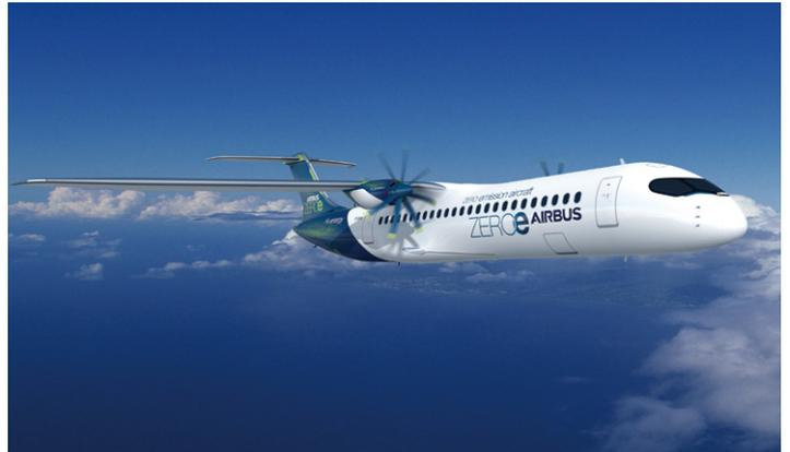
ターボファンのかわりにターボプロップエンジンを使用。改良したガスタービンエンジンで水素を燃焼し動力を得る。航続距離は1,000海里以上。近距離飛行に最適である。
