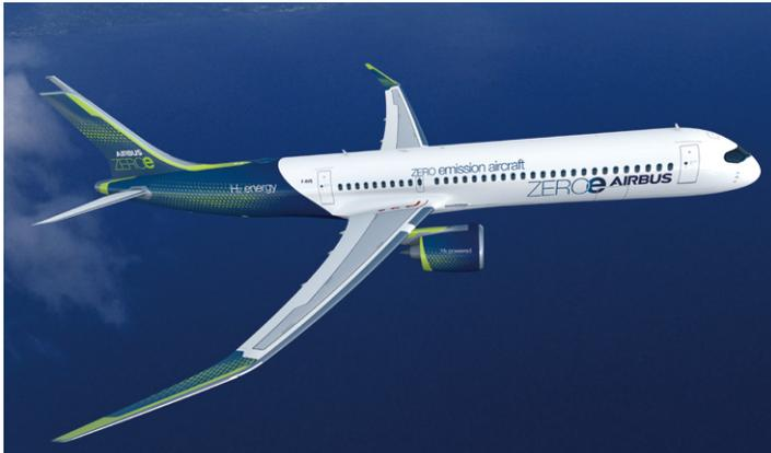
2,000海里以上の航続距離を持ち、大陸間飛行が可能。ジェット燃料ではなく水素を、改良したガスタービンエンジンで燃焼して動力を得る。液体水素は、後部圧力隔壁のうしろに設置されたタンクを使用し貯蔵、供給される。
